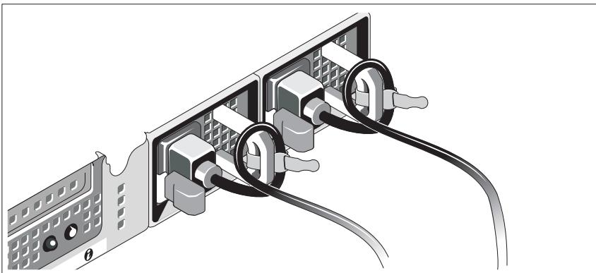
Prenda o suporte de retenção do cabo de alimentação na curva direita da alça da fonte de alimentação. Curve o cabo de alimentação, conforme mostrado na ilustração e prenda-o ao gancho localizado no suporte.
