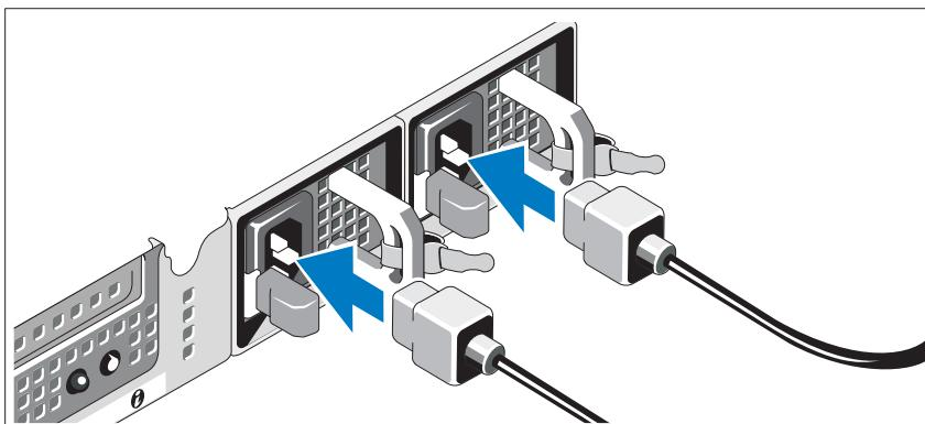
Conekte o(s) cabo(s) de alimentação ao sistema e, se for usado um monitor, coneke o cabo de alimentação do monitor.
