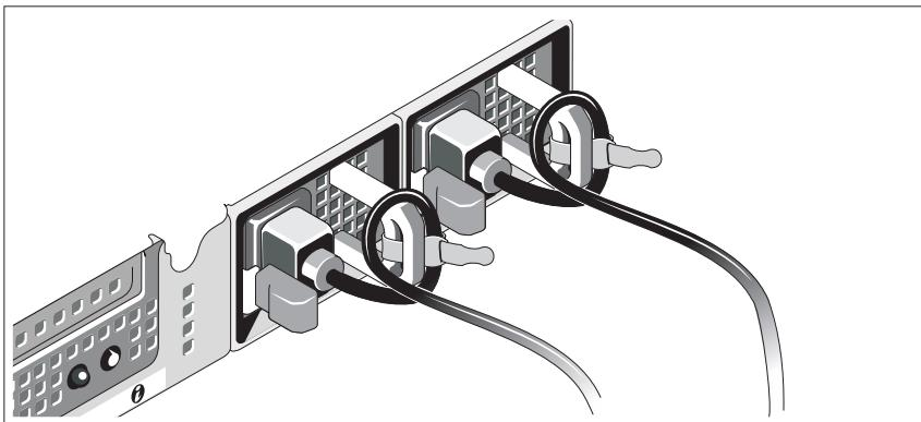
Fixez le support de fixation du câble sur la courbe droite de la poignée du bloc d'alimentation. Effectuez une boucle avec le câble d'alimentation comme indiqué dans l'illustration et insérez-le dans le clip du support.
