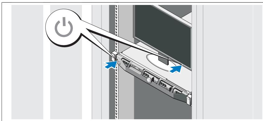
Presione el botón de encendido del sistema y del monitor. Los indicadores de alimentación deberían iluminarse.
